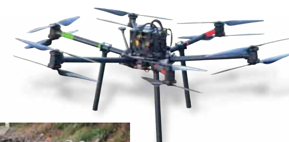
試行錯誤を繰り返し、2022年に完成した特注のドローン。15kg程度の重量に耐えられ、強風にも強い。写真左は海岸の漂着ごみ★
